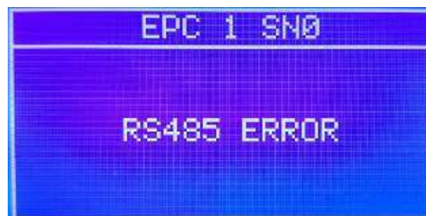
Рисунок 3.2 – Індикація помилки, якщо немає зв'язку з ЕРСом
