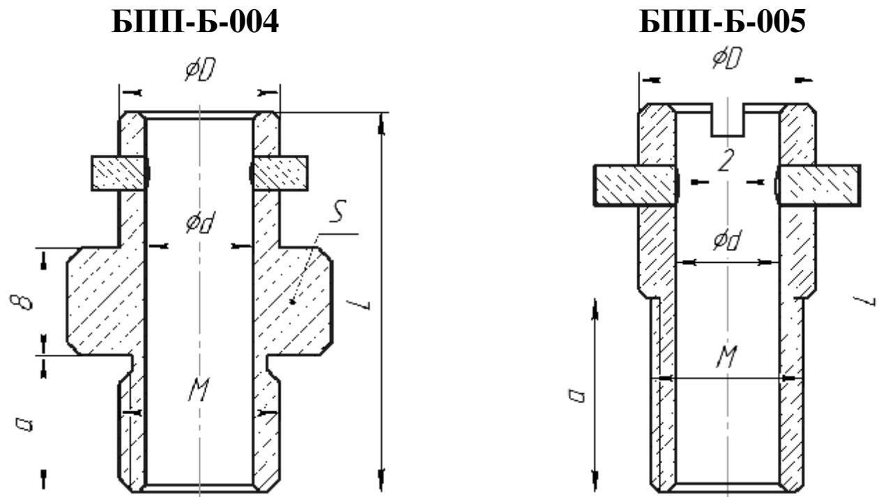
Рисунок 2.1 – Габаритно-установочные размеры БПП
