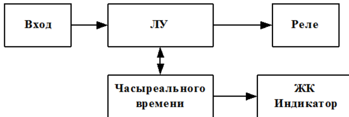
Рисунок 3.1 – Функциональная схема прибора
