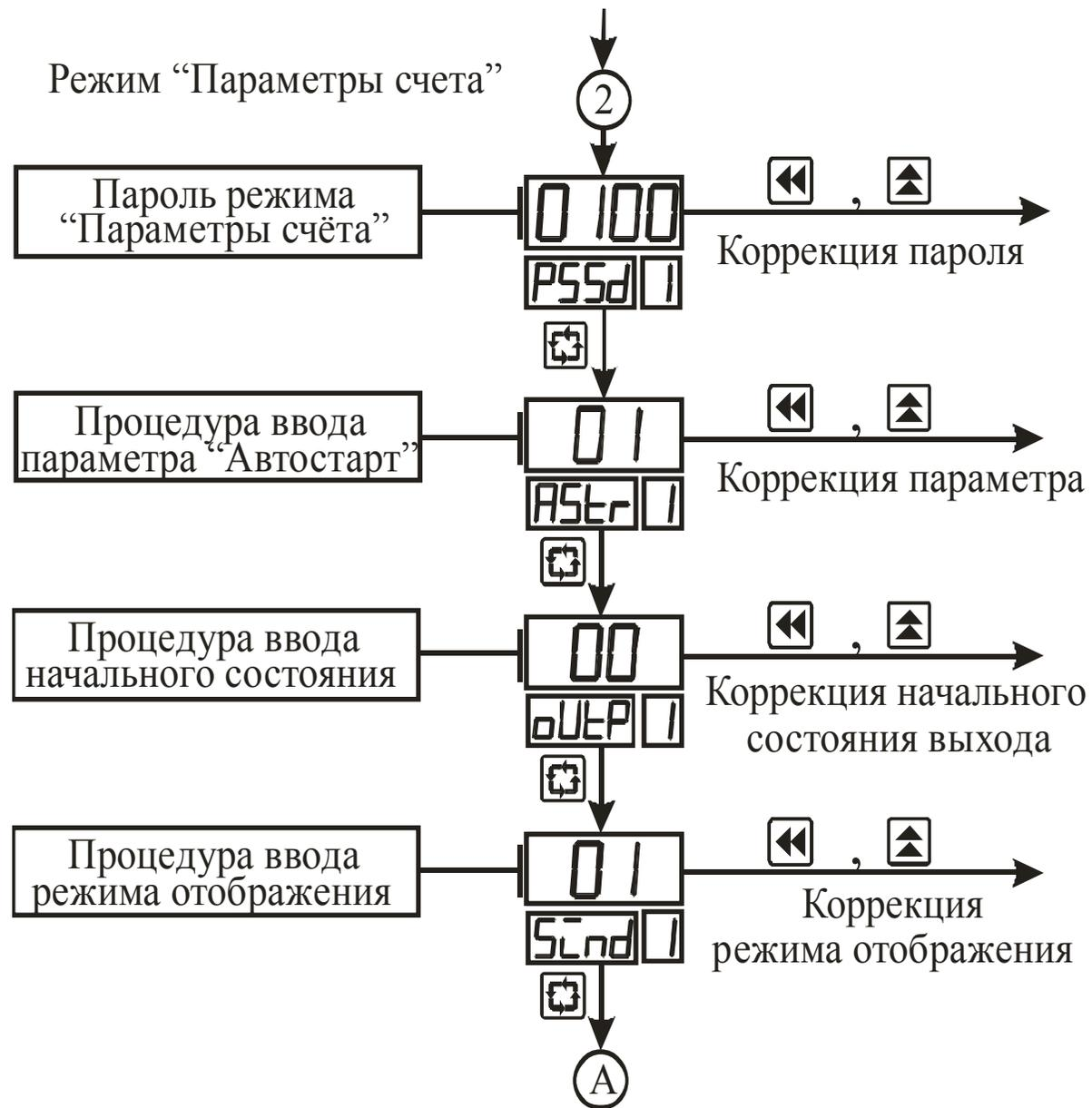
Рисунок 3.6 – Схема алгоритма работы в режиме “Параметры счёта”
