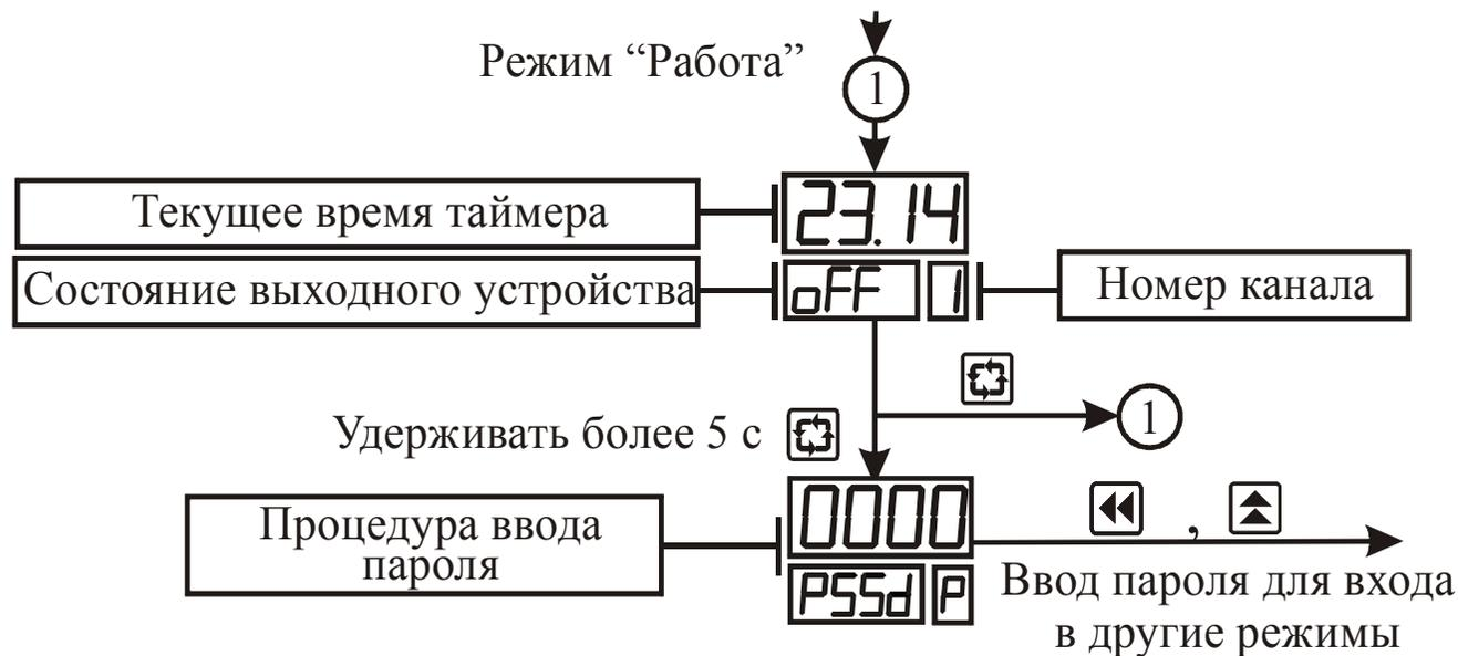
Рисунок 3.5 – Алгоритм работы прибора в режиме "Работа"
