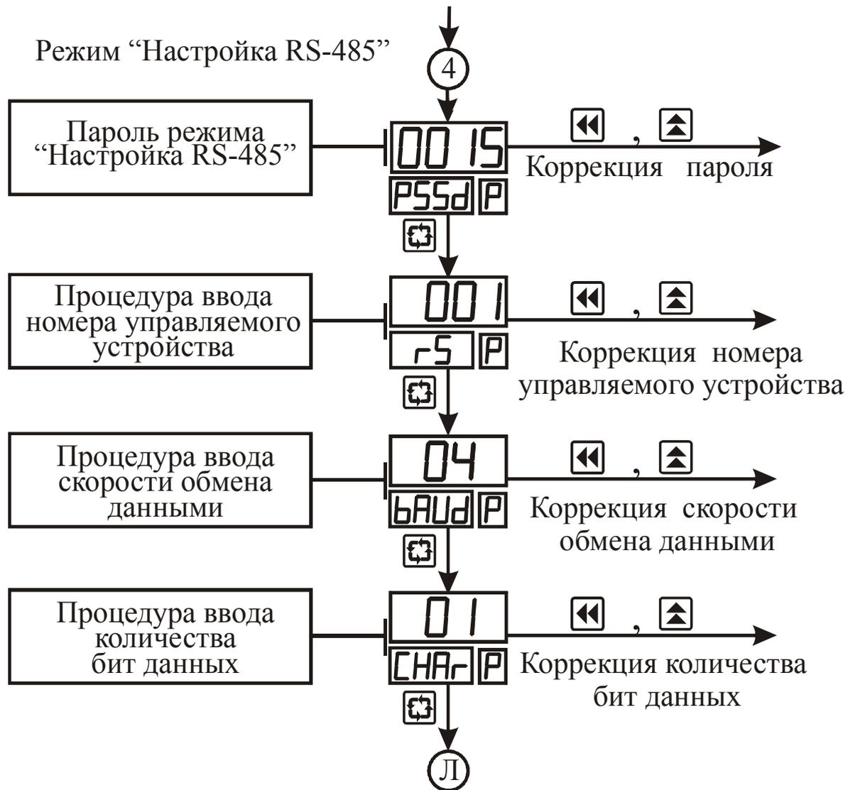
Рисунок 3.10 – Схема алгоритма работы в режиме “Настройка RS-485”
