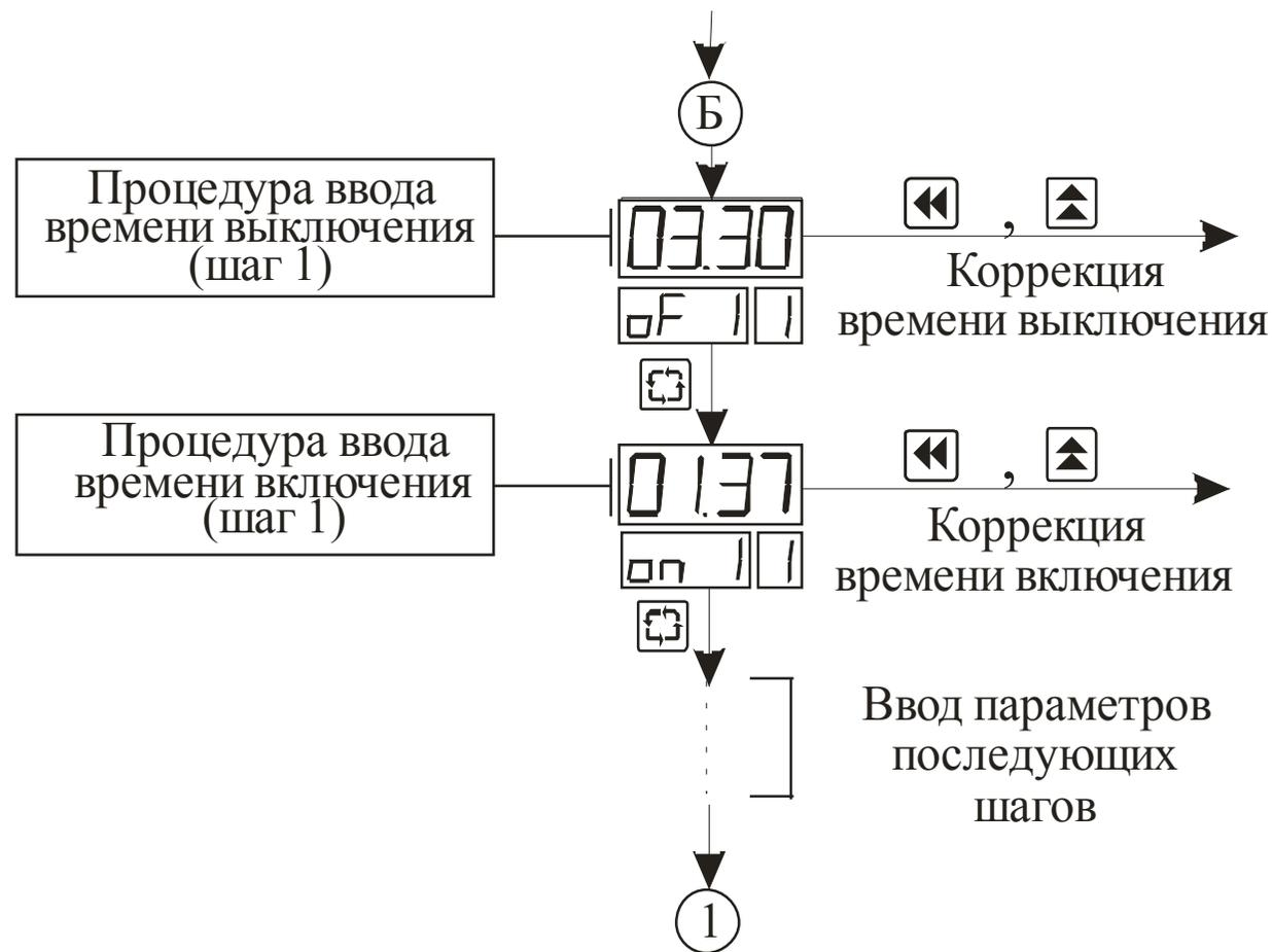
Рисунок 3.8 – Схема алгоритма работы в режиме “Параметры счёта” (окончание)
