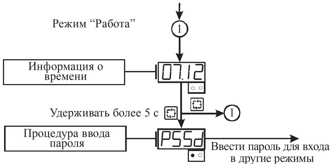
Рисунок 3.5 – Алгоритм работы прибора в режиме "Работа"
