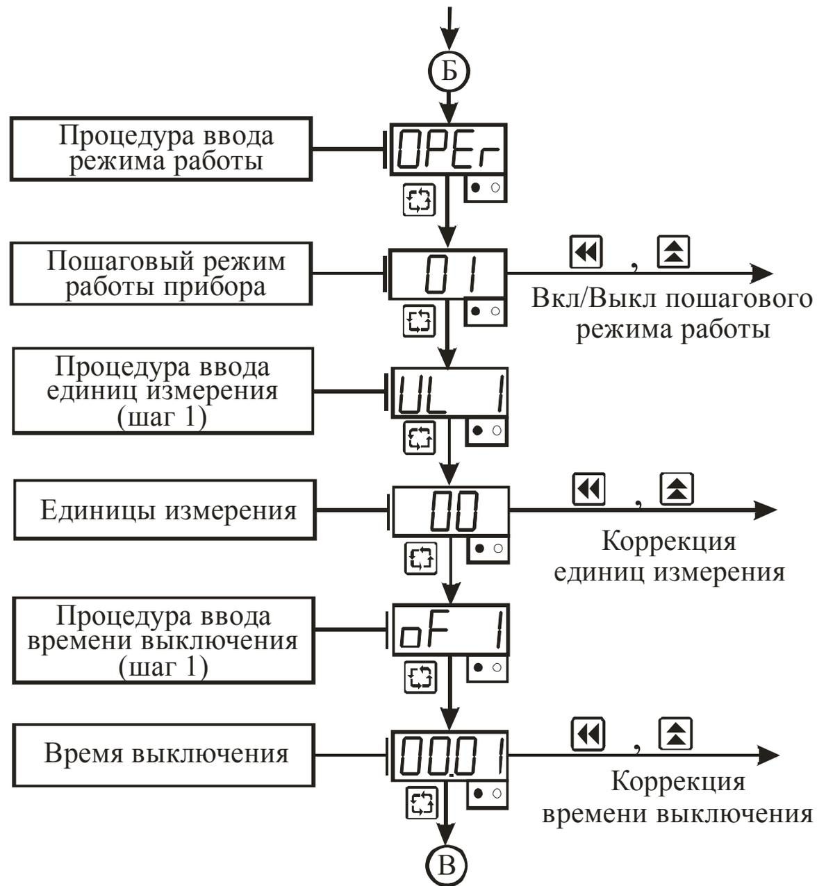
Рисунок 3.8 – Схема алгоритма работы в режиме “Параметры счёта” (продолжение)
