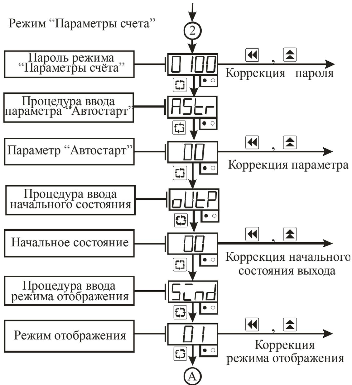
Рисунок 3.6 – Схема алгоритма работы в режиме “Параметры счёта”
