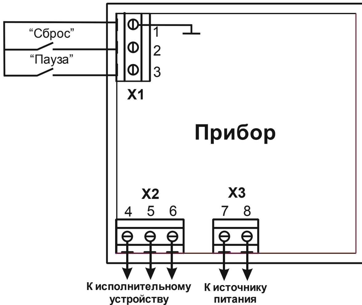
Рисунок 8.1 – Схема подключения источника питания и внешних устройств
