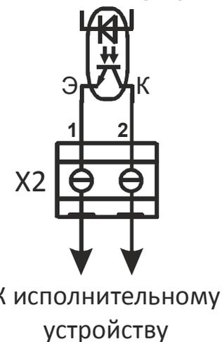
Рисунок 8.2 – Схема подключения различных исполнительных устройств
