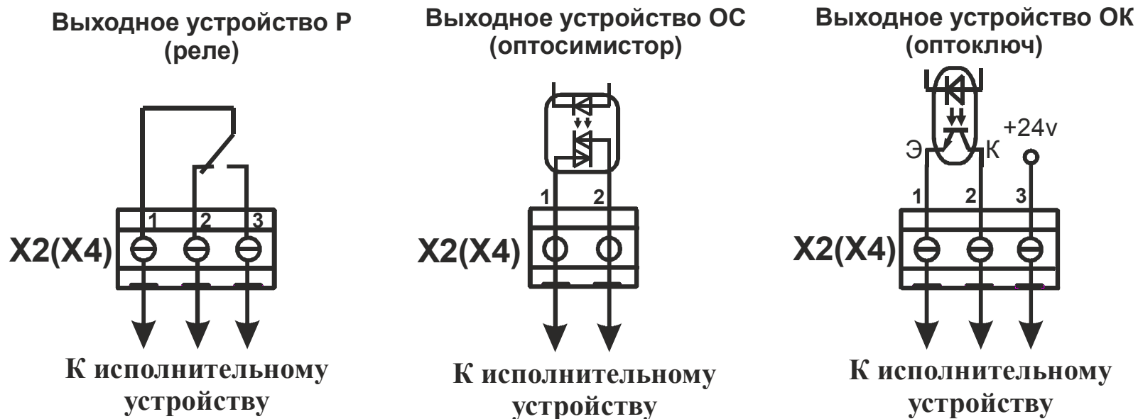
Рисунок 8.3 – Схема подключения различных исполнительных устройств
