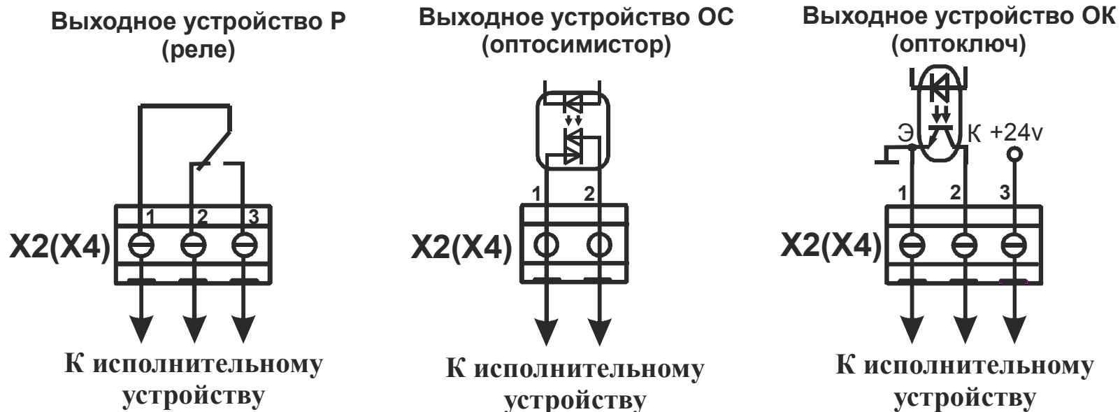
Рисунок 8.3 – Схема подключения различных исполнительных устройств
