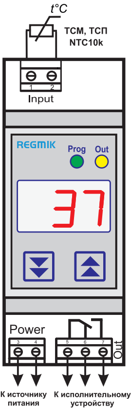
Схема подключения упрощенного регулятора
