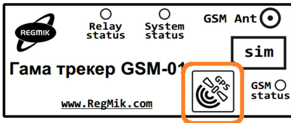
Рис.3 Расположение указателя размещения GPS антенны
