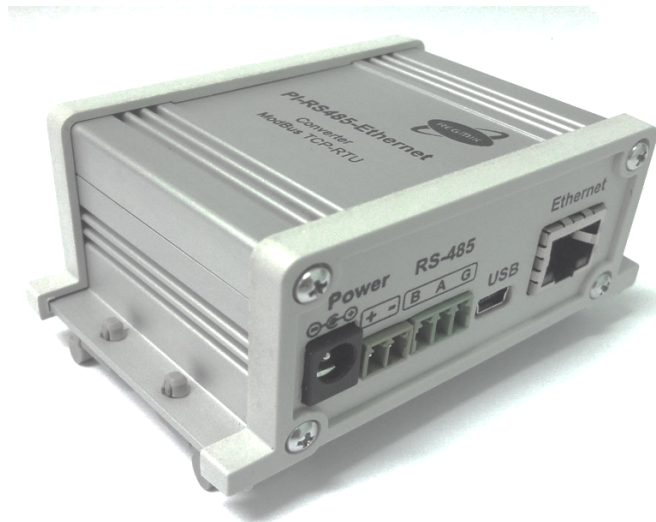
Малюнок 1 – Зовнішній вигляд перетворювача інтерфейсу «PI RS485-Ethernet»
