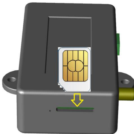
Рис.5 Установка SIM карты
