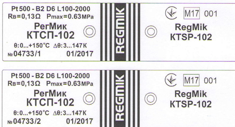
Рисунок 3 – Зразок маркування комплекту термоперетворювачів опору платинових РегМик КТСП-...
